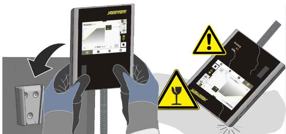
Rys. 21: Mocowanie sterownika w uchwycie przy piecu (wygląd zbliżony)
