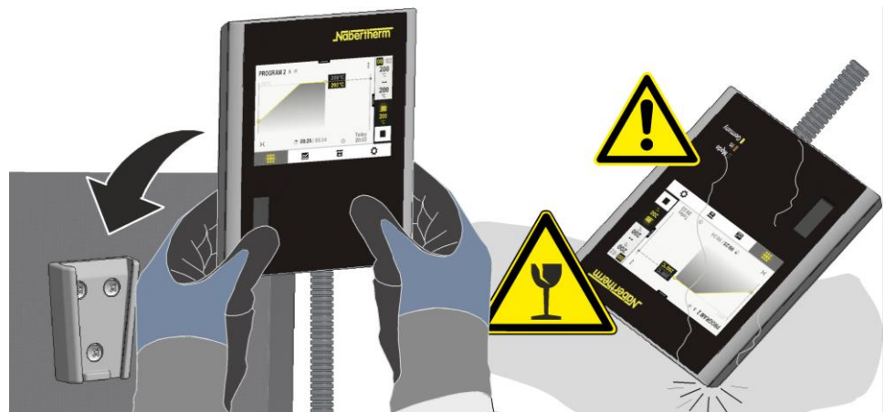
Rys. 33: Mocowanie sterownika w uchwycie przy piecu (wygląd zbliżony)
