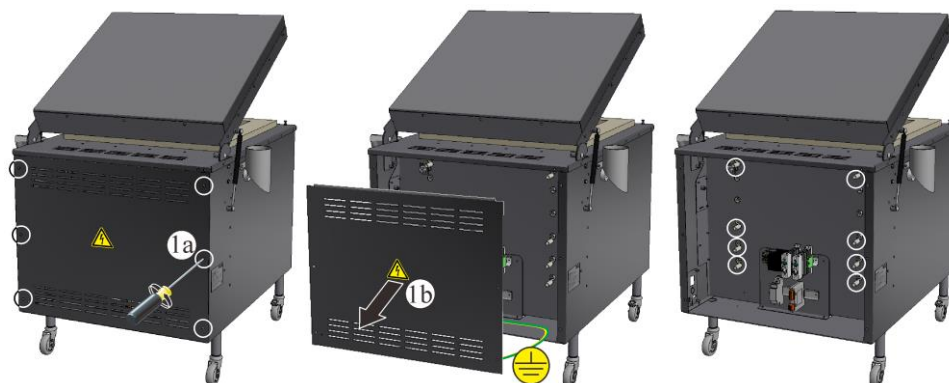
Rys. 75: Demontaż osłony rozdzielnicy z tyłu pieca (wygląd zbliżony)
