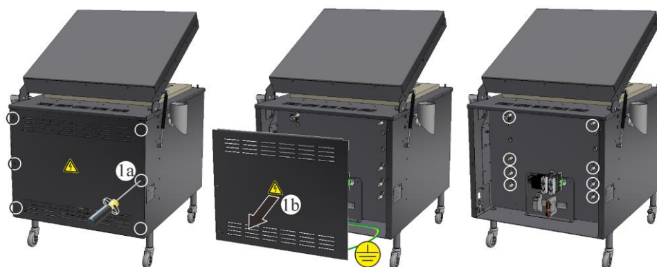
Sl. 75: demontaža poklopca rasklopnog uređaja sa stražnje strane peći (slično kao na slici)
