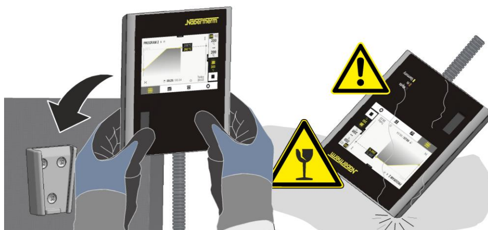
Sl. 21: umetanje upravljačkog uređaja u držač na peći (slično kao na slici)
