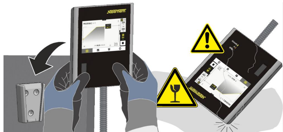
Sl. 33: umetanje upravljačkog uređaja u držač na peći (slično kao na slici)
