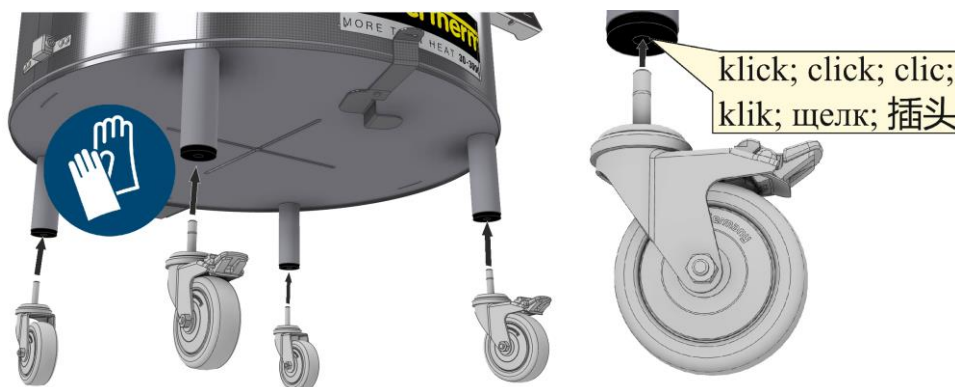
Sl. 15: montaža transportnih kotačića (slično kao na slici)
