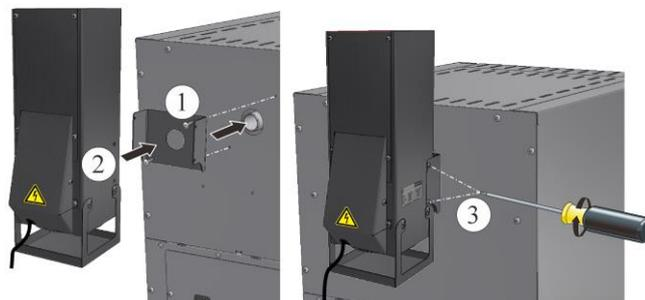
Ako montirate opciju (A), natakните nastavak za otpadni zrak na ispušni otvor na stražnjoj stijenci peći i pričvrstite ga isporučanim vijcima.
