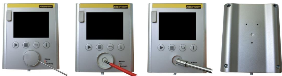
Slika 12: Odstranitev vezja krmilnika – 1. del (podobno kot na sliki)
