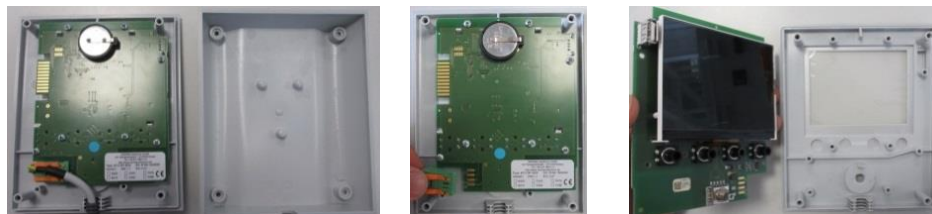
Slika 13: Odstranitev vezja krmilnika – 2. del (podobno kot na sliki)
