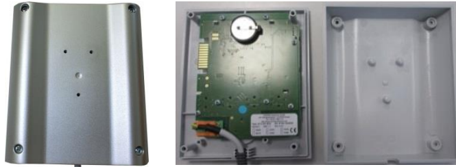
Slika 11: Zamenjava krmilnika (podobno kot na sliki)
