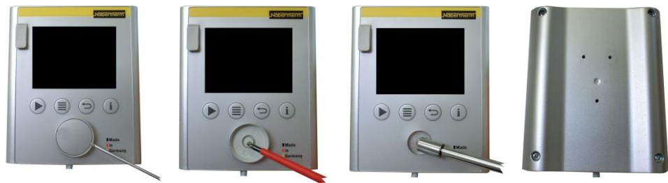
Obr. 12: Demontáž dosky riadiacej jednotky – Diel 1 (podobne ako na obrázku)
