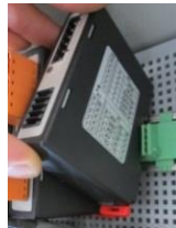
Obr. 19: Montáž modulov regulátora (podobne ako na obrázku)
