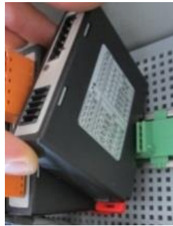
Obr. 18: Demontáž modulov regulátora – Diel 2 (podobne ako na obrázku)
