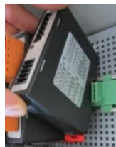
Fig. 19: Montagem do módulo do regulador (figura semelhante)
