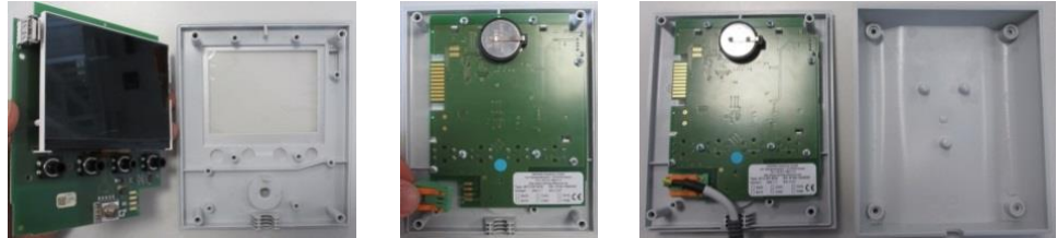
Fig. 15: Montagem da placa do controlador – parte 2 (figura semelhante)
