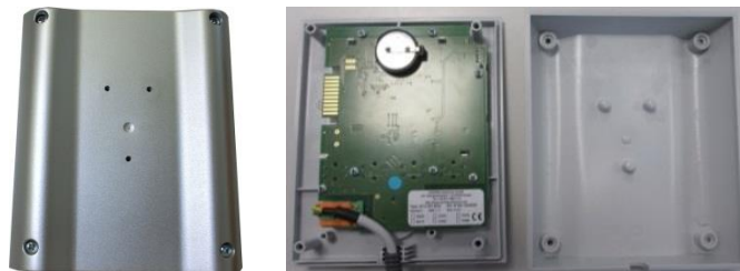
Fig. 11: Substituição de um controlador (semelhante à figura)
