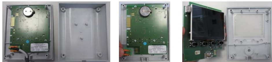
Fig. 13: Desmontagem da placa do controlador – parte 2 (figura semelhante)
