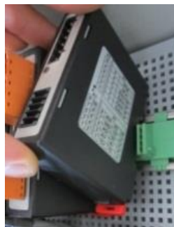
Fig. 18: Desmontagem do módulo do regulador – parte 2 (figura semelhante)
