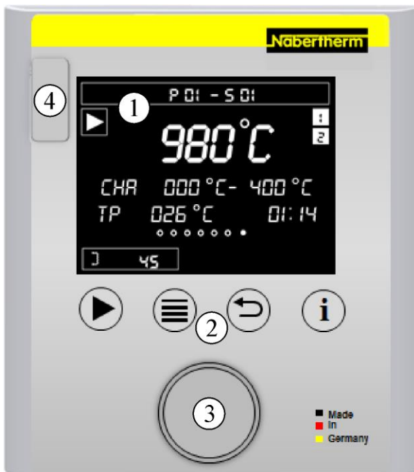
Fig. 3: Painel de controlo B400/C440/P470 (figura semelhante)
