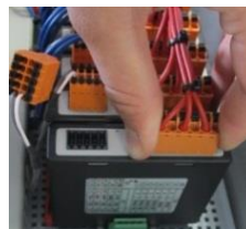
Fig. 19: Montagem do módulo do regulador (figura semelhante)
