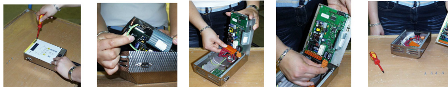
Abb. 28: Byte av controller
