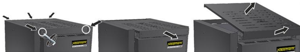
Att. 56: modeļa LHT 03/17 D pārsega demontāža (skatīt attēlu)
