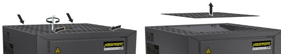
Att. 17: modeļa LHT 01/17 D pārsega demontāža (skatīt attēlu)
