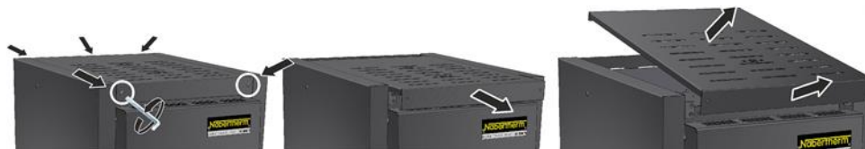
Att. 37: modeļa LHT 03/17 D pārsega demontāža (skatīt attēlu)
