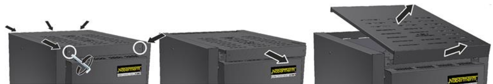
Att. 45: modeļa LHT 03/17 D pārsega demontāža (skatīt attēlu)
