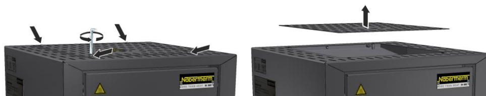
Fig. 44: Smontaggio copertura modello LHT 01/17 D (illustrazione simile)
