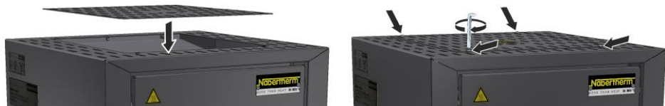
Fig. 39: Montaggio copertura modello LHT 01/17 D (illustrazione simile)
