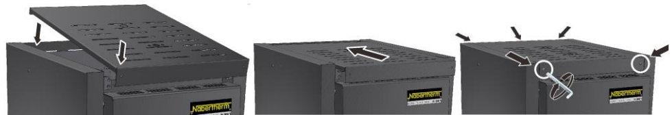
Fig. 40: Montaggio copertura modello LHT 03/17 D (illustrazione simile)
