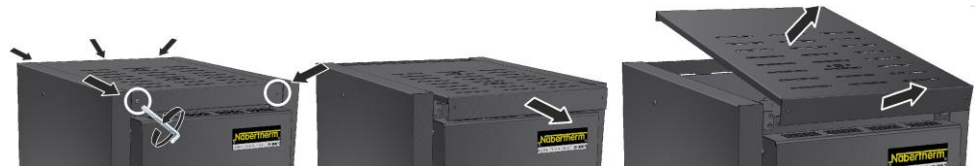
Fig. 37: Smontaggio copertura modello LHT 03/17 D (illustrazione simile)
