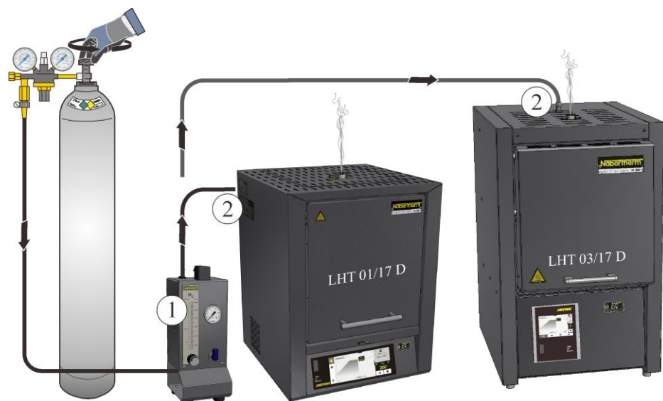
Fig. 64: Collegamento al sistema di gasaggio (illustrazione simile)
