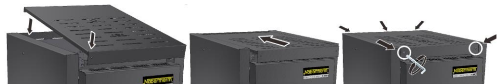
Fig. 52: Montaggio copertura modello LHT 03/17 D (illustrazione simile)
