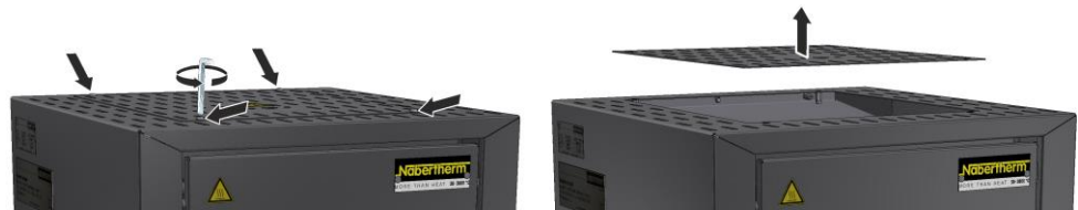
Fig. 17: Smontaggio copertura modello LHT 01/17 D (illustrazione simile)
