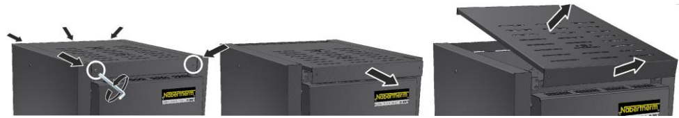
Fig. 45: Smontaggio copertura modello LHT 03/17 D (illustrazione simile)
