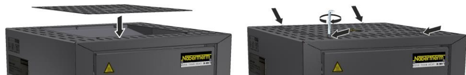
Fig. 51: Montaggio copertura modello LHT 01/17 D (illustrazione simile)
