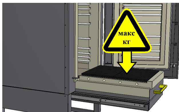
Рис. 73. Максимальный вес садки (NW 150../NW 200../NW 300..) (изображение приближенное)
