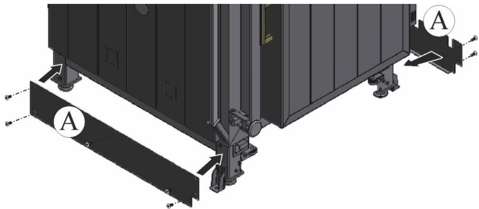
Рис. 46. Монтаж боковых панелей (рисунок примерный)
