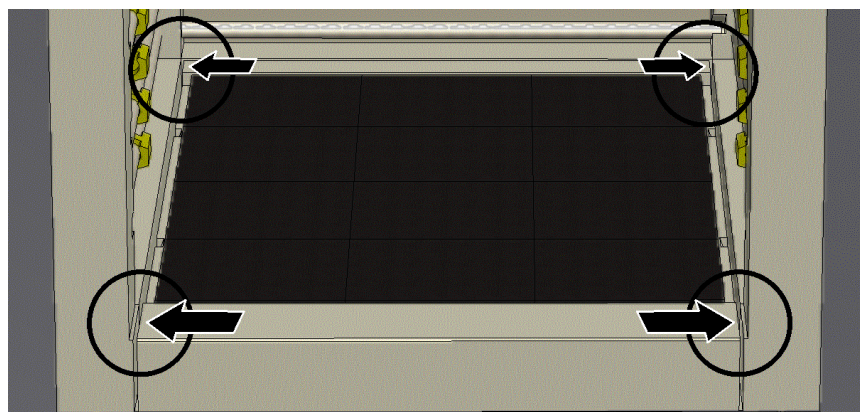
Рис. 43. Проверка высоты по всей длине (рисунок примерный)
