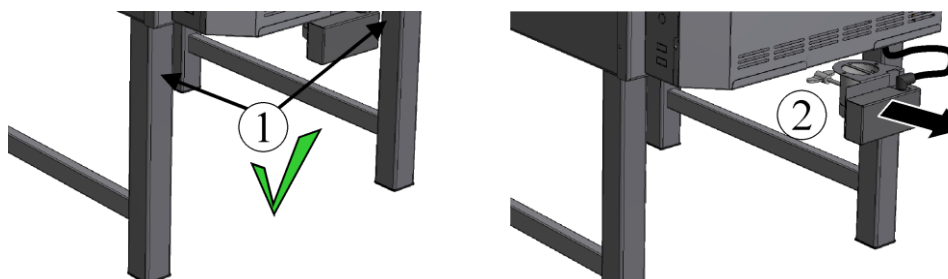
Рис. 52. Извлечение клапана приточного воздуха из крепления (рисунок примерный)
