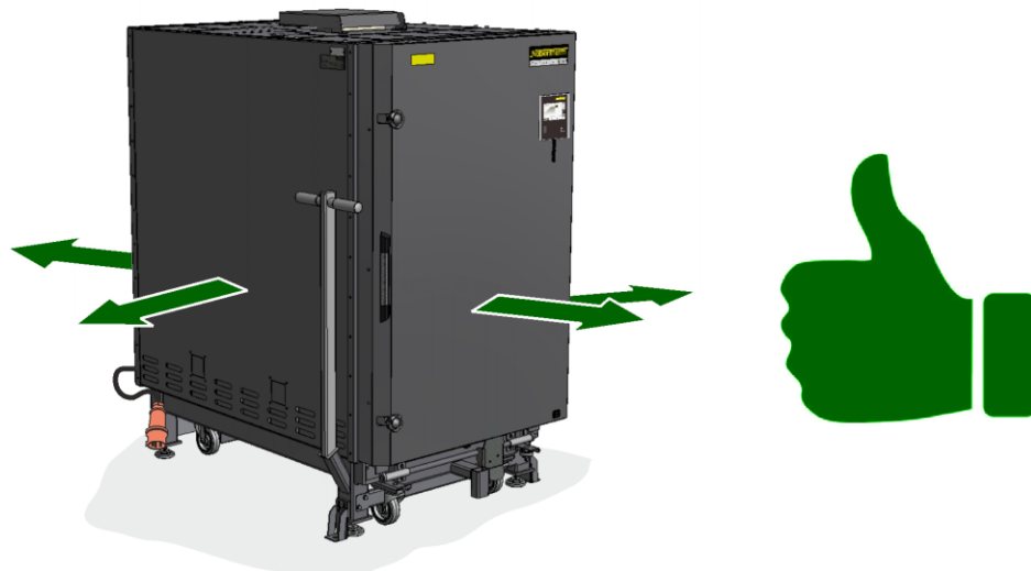
Рис. 38. Опускание и позиционирование печи (примерное изображение)
