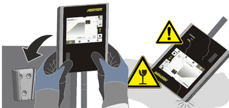
Рис. 71. Вставьте контроллер в держатель, находящийся у печи (рисунок примерный)
