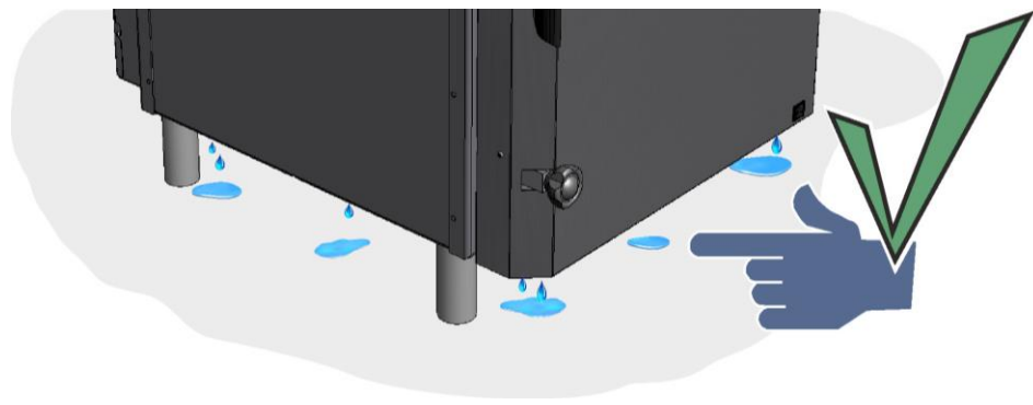
Εικ. 67: Συσσωρεύσεις συμπυκνωμάτων κατά τη διάρκεια των πρώτων ψησιμάτων (παρόμοια με την εικόνα)
