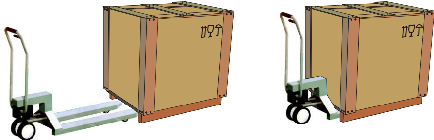
Εικ. 14: Το ανυψωτικό όχημα έχει τοποθετηθεί ολόκληρο κάτω από το πλαίσιο μεταφοράς
