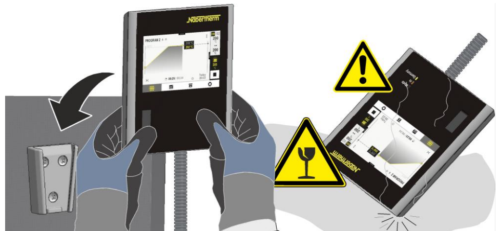
Εικ. 71: Τοποθετήστε τον ελεγκτή στο στήριγμα που βρίσκεται στον κλίβανο (ανάλογα με το μοντέλο)
