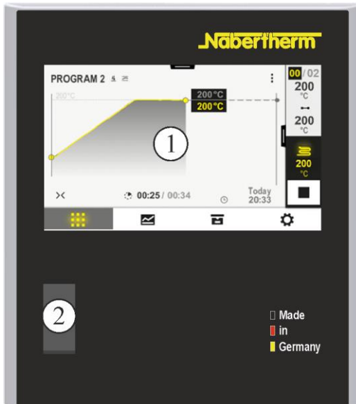
Εικ. 69: Πίνακας ελέγχου B500/C540/P570 (παρόμοια με την εικόνα)
