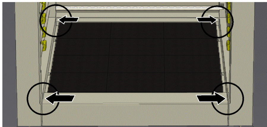
Fig. 43: Kontrollerer højden over hele længden (eksempelbillede)
