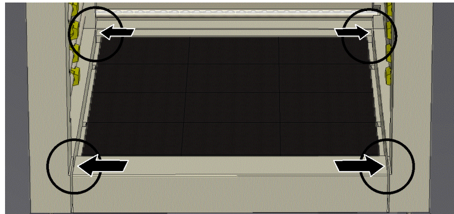
Obr. 36: Kontrola výšky po celé délce (přibližný obrázek)
