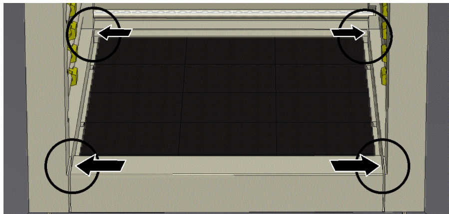
Obr. 42: Kontrola výšky po celé délce (přibližný obrázek)
