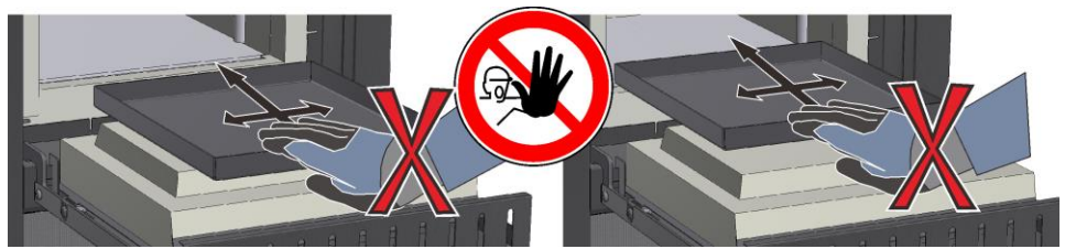
Obr. 36: Príklad: Poškodenie izolácie dverí (podobne ako na obrázku)
