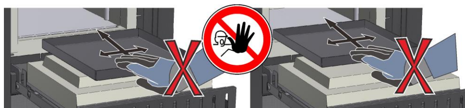
Fig. 36: Eksempel: Unngå skader på dørisolasjonen (illustrasjonen kan avvike)
