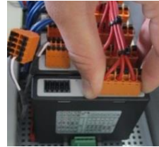
Fig. 11: Montaggio dei moduli regolatore (illustrazione simile)
