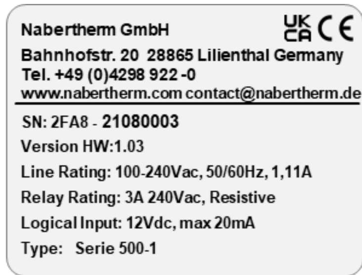
Fig. 7: Esempio: (targhetta dati dell'unità di comando)
