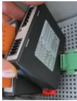
Fig. 10: Smontaggio dei moduli regolatore – Parte 2 (illustrazione simile)
