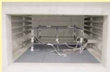
アニーリング炉での測定設置
