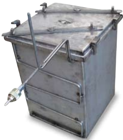
Begasungskasten mit Verschlussriegel
