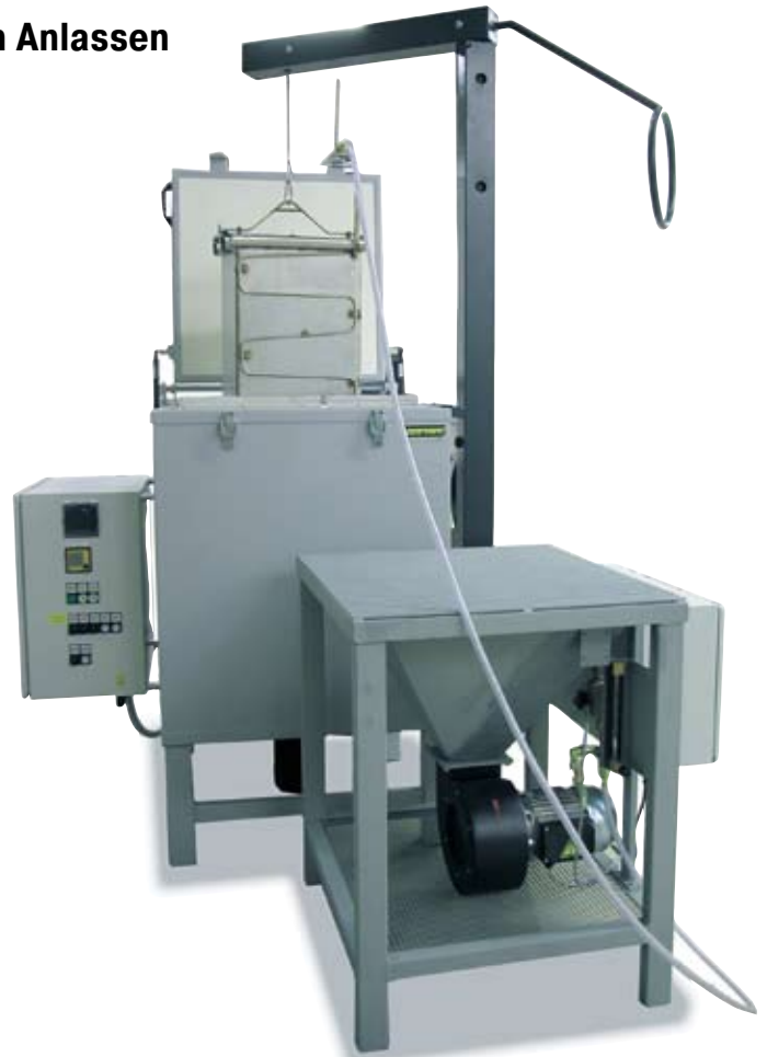
S 120/65A mit Beschickungshilfe und Kühltisch als Zusatzausstattung
