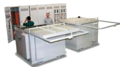
Salzbadanlage zum Glühen von Aluminium- bauteilen in der Luftfahrtindustrie
