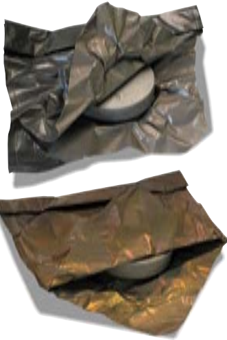
Werkstücke in Härtefolie
