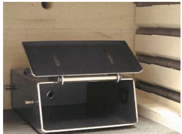
Begasungskasten mit Klappdeckel für Dauerbetrieb
