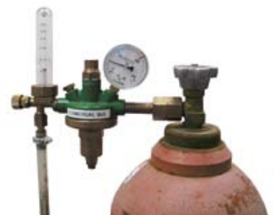
Druckreduzierventil mit Durchflussmengenmesser
